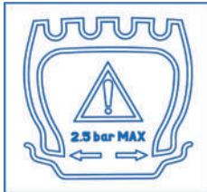
**ВАЖНО!** Обратите внимание, что давление, указанное на шине в виде знака, не является правильным давлением для эксплуатационного давления в шине. **Этот знак определяет давление только для монтажа шины на обод** **ВАЖНО!**
